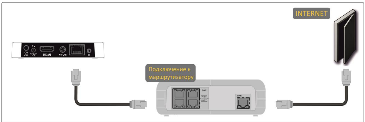
Рисунок 10 – Подключение к сети провайдера, используя маршрутизатор
